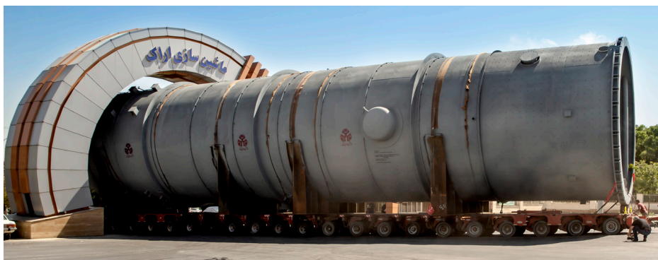
Aryan Dipolymer Petrochemical Distillation Towers (ASALUYEH) Methanol Design برج های تقطیر پتروشیمی دی پلیمر آراین (عسلویه) طرح متانول T-1001 Tower 233 Ton Weight 24 M Diameter 4 M (SA 516-70 + Cladss.321) وزن ۲۳۳ تن طول ۲۴ متر قطر ۴ متر (SA 516-70 + Cladss.321) T-3001 tower weighing 136 tons 40 meters long 4.5 meters in diameter وزن ۱۳۶ تن طول ۴۰ متر قطر ۴.۵ متر
