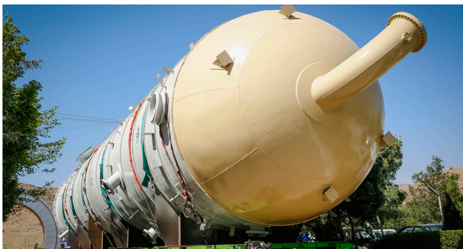
Kangan Petroleum Refinery Tower برج دی اتانایزر پروژه پتروپالایش کنگان Diameter of 5800mm, length of 39000mm and 54mm thick and weighs 320 tons. قطر داخلی ۵۸۰۰ میلیمتر و طول ۳۹۰۰۰ میلیمتر و ضخامت ۵۴ میلیمتر و وزن ۳۲۰ تن
