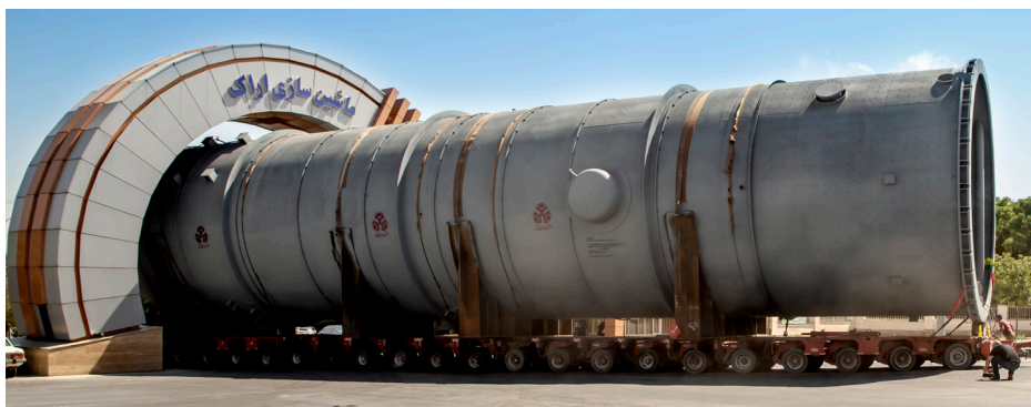
Engineering, procurement, manufacture of Gachsaran Petrochemical Tower طراحی، تامین مواد، ساخت و ارسال برج پتروشیمی گچساران وزن ۱۶۰ تن، قطر ۷ متر و طول ۳۵ متر Weight 160 tons, diameter 7 meters and length 35 meters
