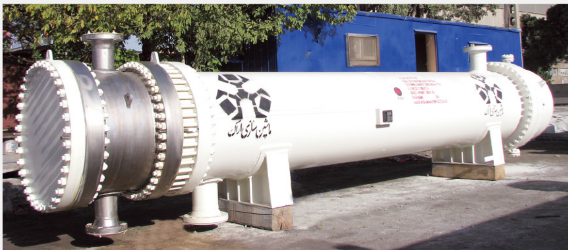
چنل از جنس تیتانیوم Titanium channel
